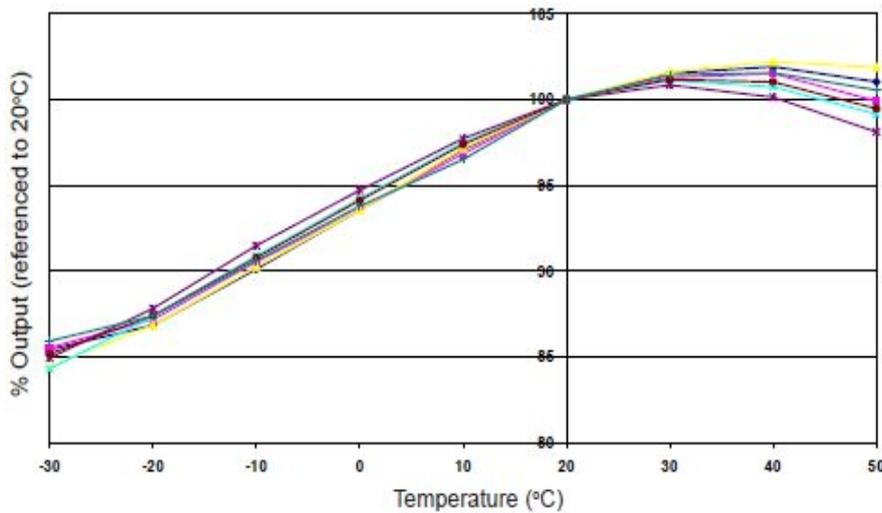
图2显示了由温度变化引起的传感器灵敏度改变。
