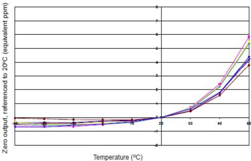
图3 显示了由温度变化引起的零点输出变化，表示为等效的ppm值，并参考20°C时的零点。
