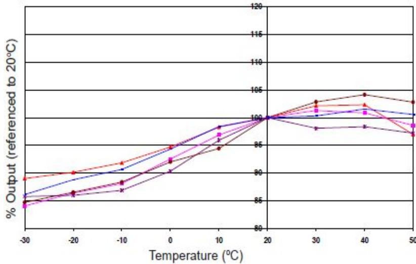
图2显示了由温度变化引起的灵敏度改变。
