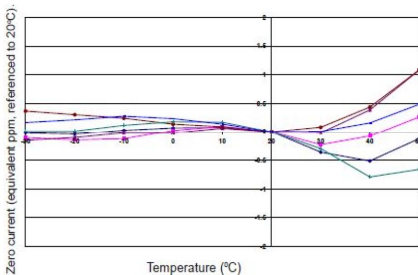
图3 显示了由温度变化引起的工作电极零点输出变化，用等效的ppm值表示，参考20°C时的零点。
