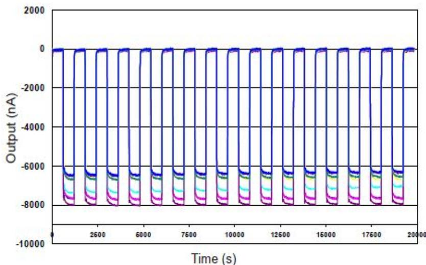
如图4所示，重复用20ppm NO<sub>2</sub>做气体处理时，传感器的反应依然稳定。
