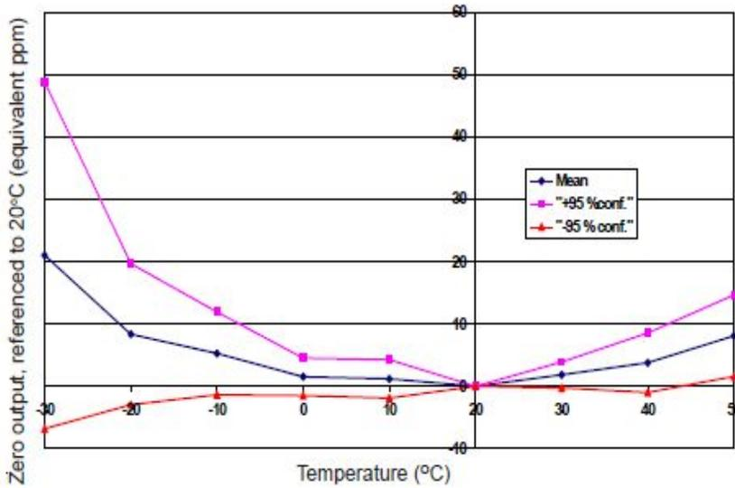
图2显示了温度变化引起的零点输出变化，用等效的ppm值表示，参考20°C时的零点。
